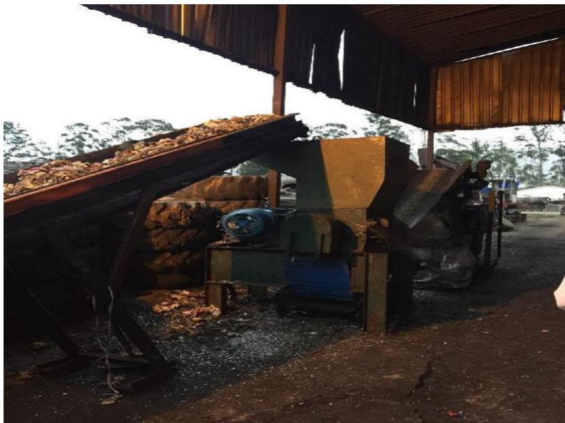
**Figura 3.6** – Segunda etapa de trituração da amostra (FURNAS; CARBOGAS, 2016)
