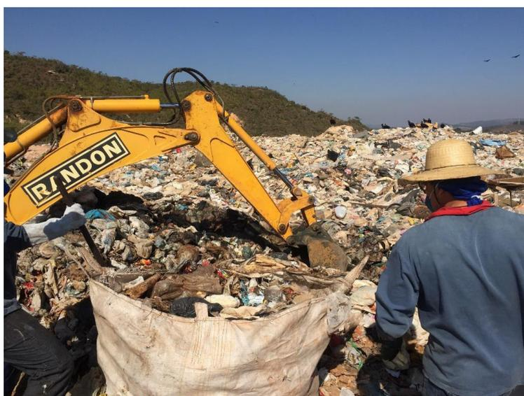
**Figura 3.3** – Um dos pontos aleatórios de coleta de amostra no aterro (FURNAS; CARBOGAS, 2016)
