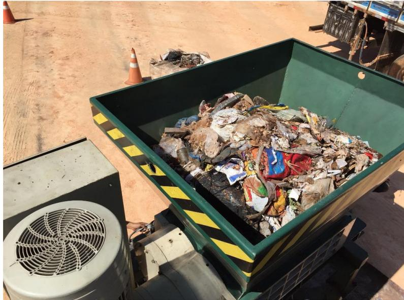
**Figura 3.5** – Primeira etapa de trituração da amostra em campo (FURNAS; CARBOGAS, 2016)
