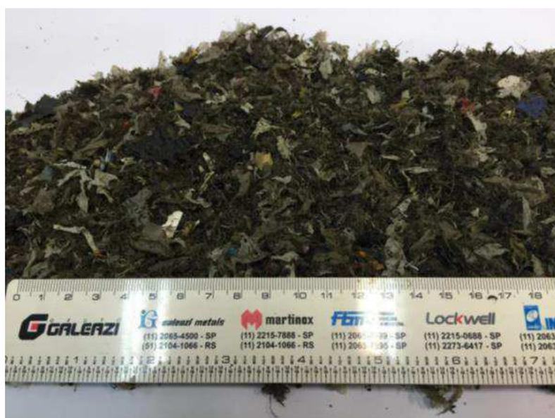
**Figura 4.1** – Amostras enviadas para laboratório, granulometria média final de 10 mm (FURNAS; CARBOGAS, 2016).
