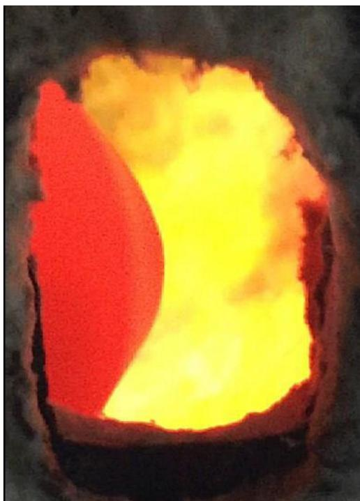
**Figura 4.2** – Chama na fornalha indicando a presença do gás produzido (FURNAS; CARBOGAS, 2016)
